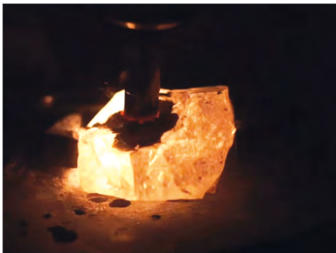
Figura 36. Triboluminiscencia del cuarzo cuando se perfora con una broca de diamante. Captura pantalla: Adolf Cortel; fuente: video https://www.youtube.com/watch?v=FFukQowqGPg .
