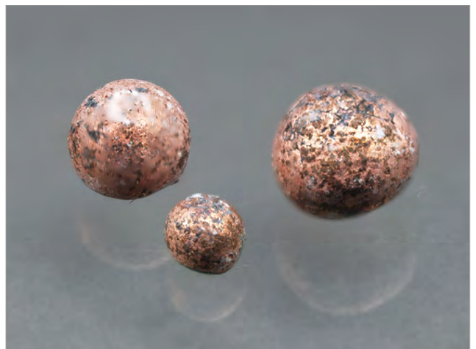
Figura 12. Règuls de coure metàl·lic, obtinguts per fusió de cuprita de l'aflocament de Gebut, Soses, Lleida. C.V. 8,5 mm. Foto: Joan Rosell.
