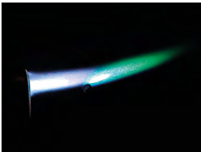
Figura 11. Color de la flama típica del coure, obtinguda de la pols mineral en filferro de platí. Foto: Alfonso Calero.
